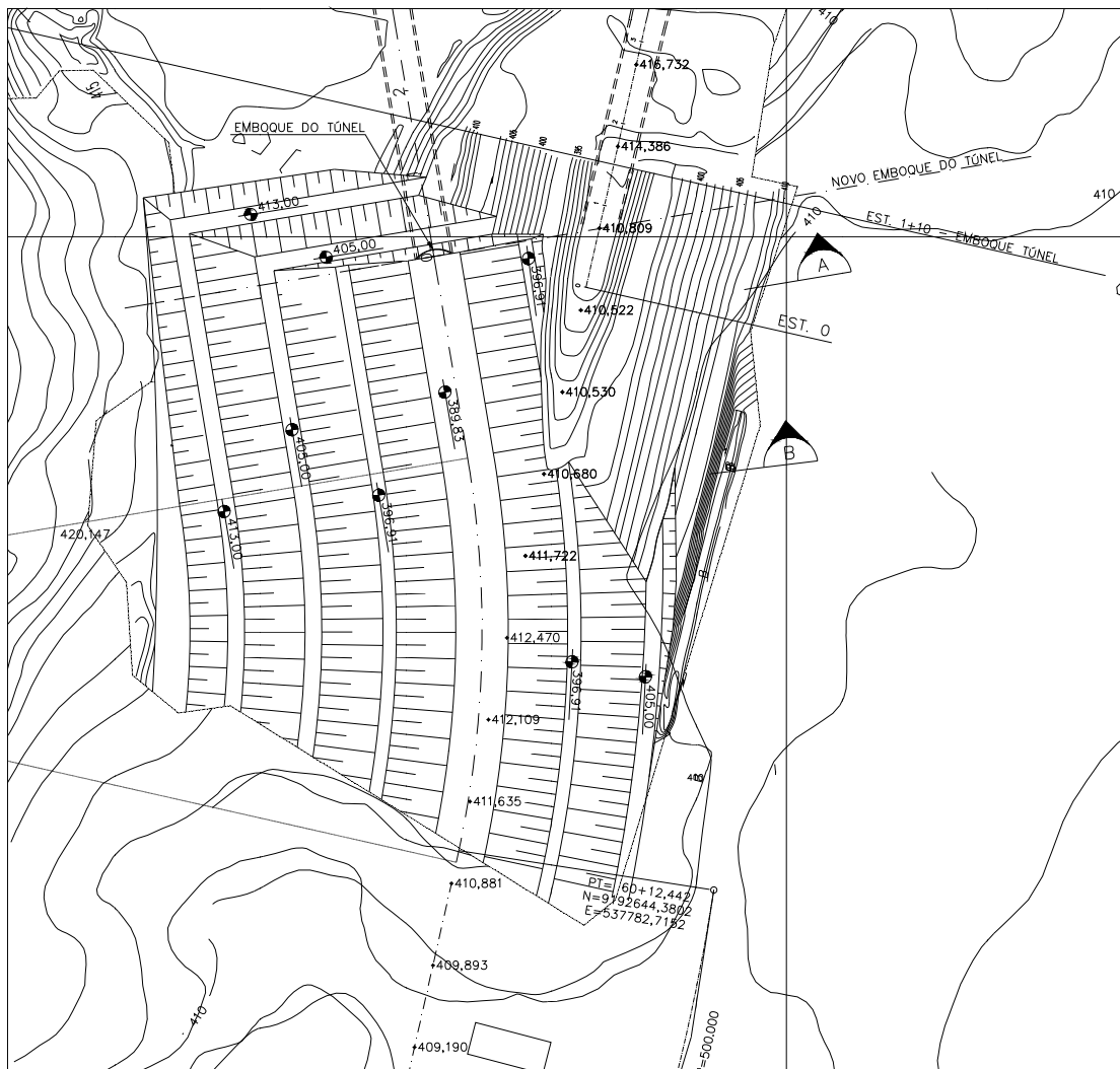
Figura 18 - Implantação do novo canal até o novo emboque
